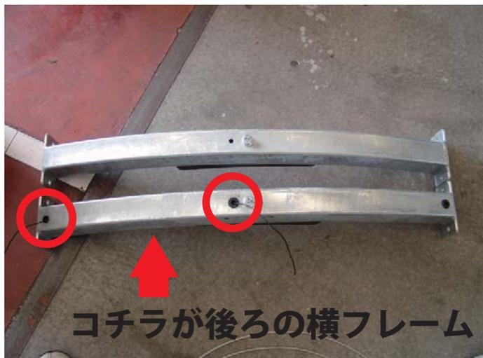
フレームの向きを変え、横フレームを仮止めしていきます。
