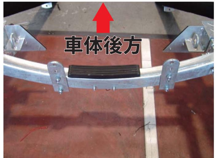
ウッドレーンとステーをボルトで付け、幅や角度などを調整します。
