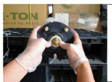
アウターにベアリングをはめ、 ワッシャー・ロックワッシャーを 付けて車軸に戻して下さい。
