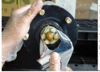
ハブを車軸に取り付けたらキャッスルナットで 固定して下さい。 ※このとき締め過ぎ、緩み過ぎ にご注意ください。 ハブがスムーズに回り、かつガタが 出ないように調整するのが理想です。 締めすぎると焼きつく可能性がありますので 十分注意すて行ってください。
