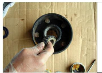
オイルシールを取り外すと ベアリングが見えますので、 ベアリングも取り外して 下さい。
