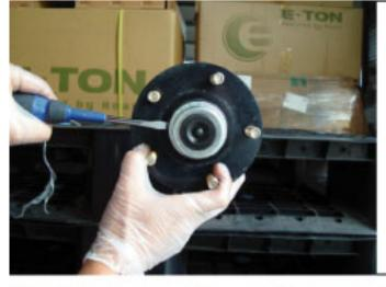
ハブキャップとハブの間に マイナスドライバー等を 入れて頂き、ハブキャップを 取り外して下さい。
