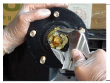
モンキーレンチを使用して キャッスルナットを取り外して下さい。
