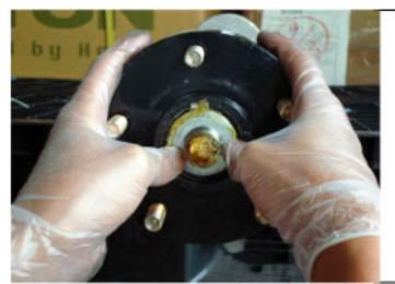
ワッシャーを落とさないよう 押さえてハブを引き抜いて 取り外して下さい。
